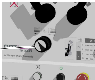
Obr. 4-2: Volicí páka směru posuvu
