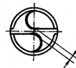
Querschneidenlänge 10 % vom Bohrer – \phi
