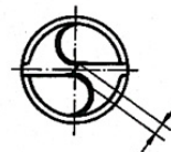
Querschneidenlänge 10 % vom Bohrer – \phi
