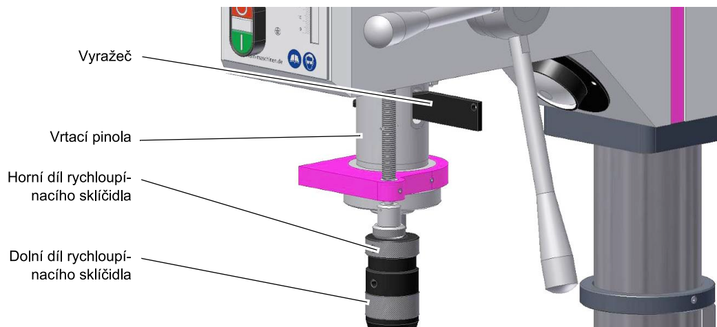
Obr. 4-10: Demontáž pomocí vyražeče
