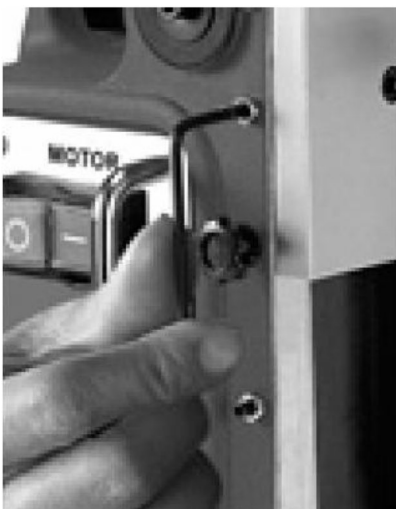
Obr. 24: Nastavení vůle ve vedení
