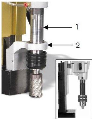
Obr. 15: Montáž vrtacího sklíčidla
