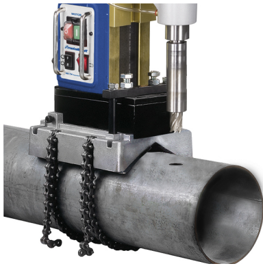
Obr. 11: Bezpečnostní řetěz s přípravkem pro upnutí MB 754 na potrubí
