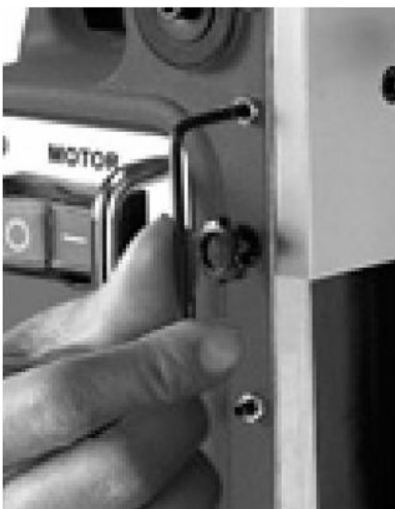
Obr. 24: Nastavení vůle ve vedení
