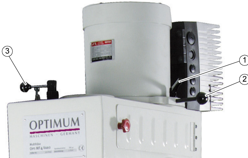
Obr.4-17: Nastavení otáček vřetene pomocí řemenic
